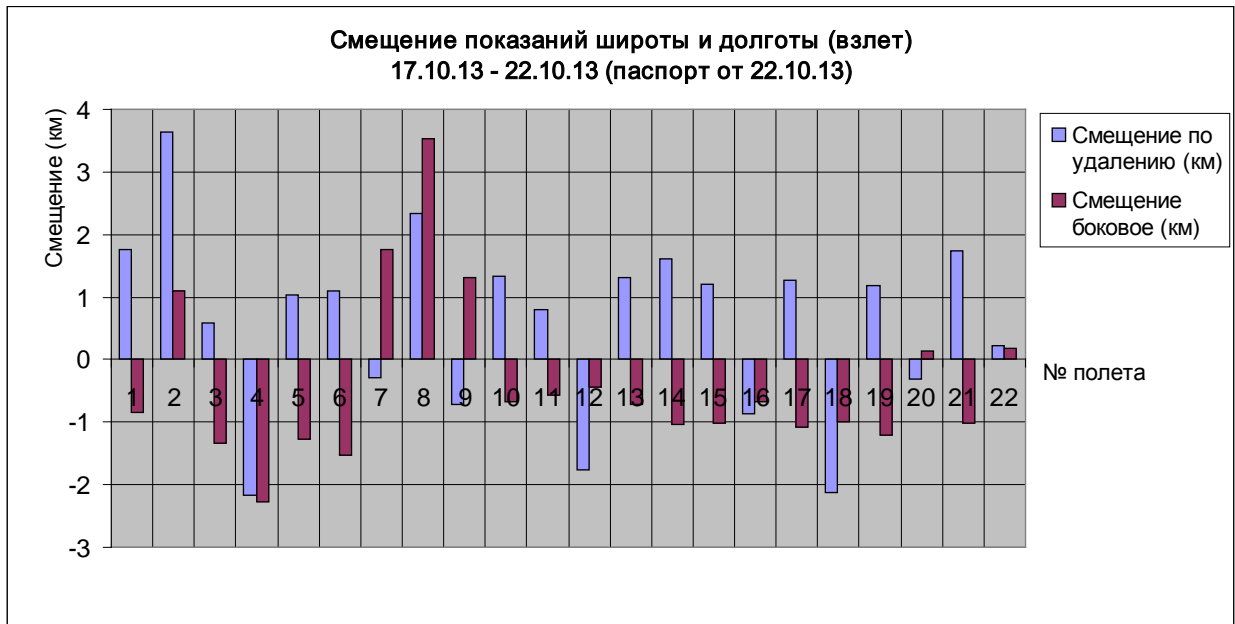
Рисунок 80. Погрешность определения местоположения инерциальной системой при взлетах 17.10-22.10.2013
