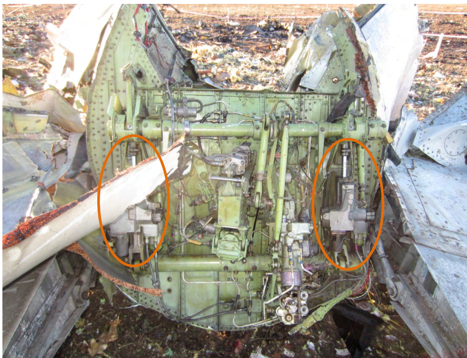
Рисунок 2. Внешний вид района шпангоута 1156 на месте АП (оранжевым цветом выделены рулевые приводы руля высоты)
