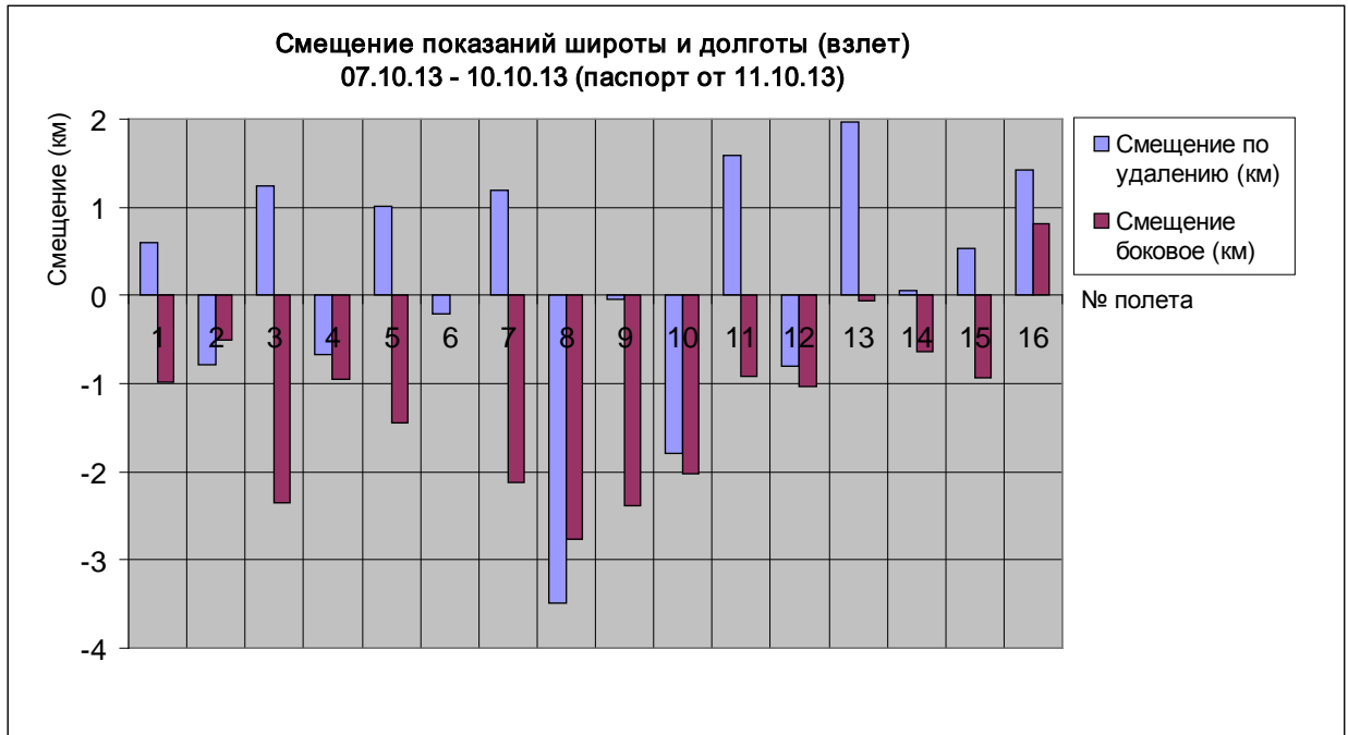
Рисунок 79. Погрешность определения местоположения инерциальной системой при взлетах 07.10-10.10.2013
