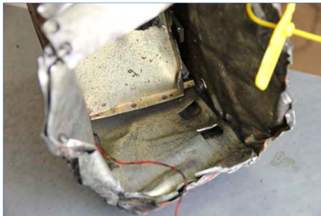
Рисунок 13. Контейнер регистратора речи без модуля памяти
