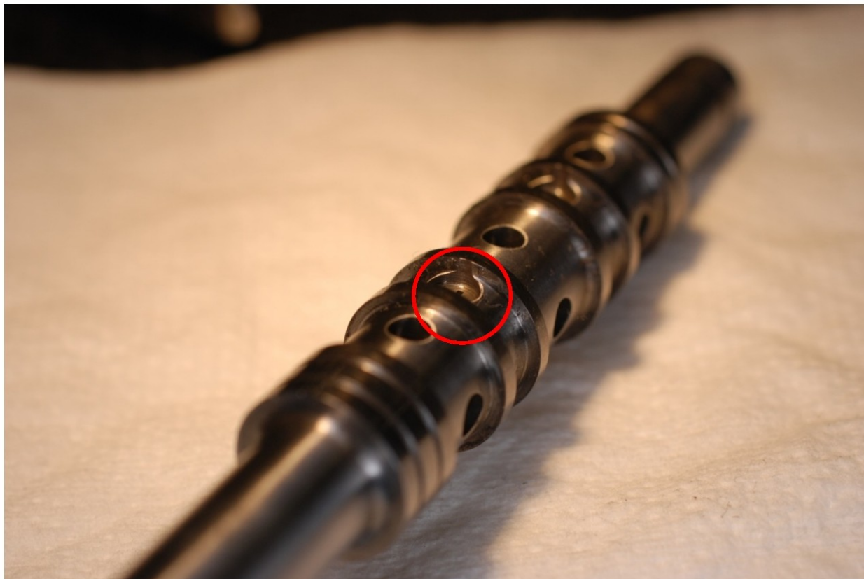
Рисунок 68. «Зарез» бурта вторичного золотника распределительного устройства правого рулевого привода
