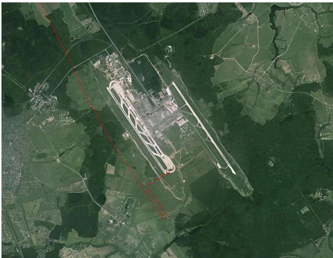
Рисунок 82. «Сдвиг карты» при выполнении взлета в аэропорту Домодедово
