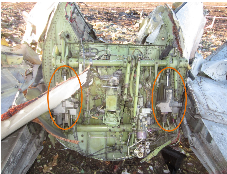
Рисунок 2. Внешний вид района шпангоута 1156 на месте АП (оранжевым цветом выделены рулевые привода руля высоты)
