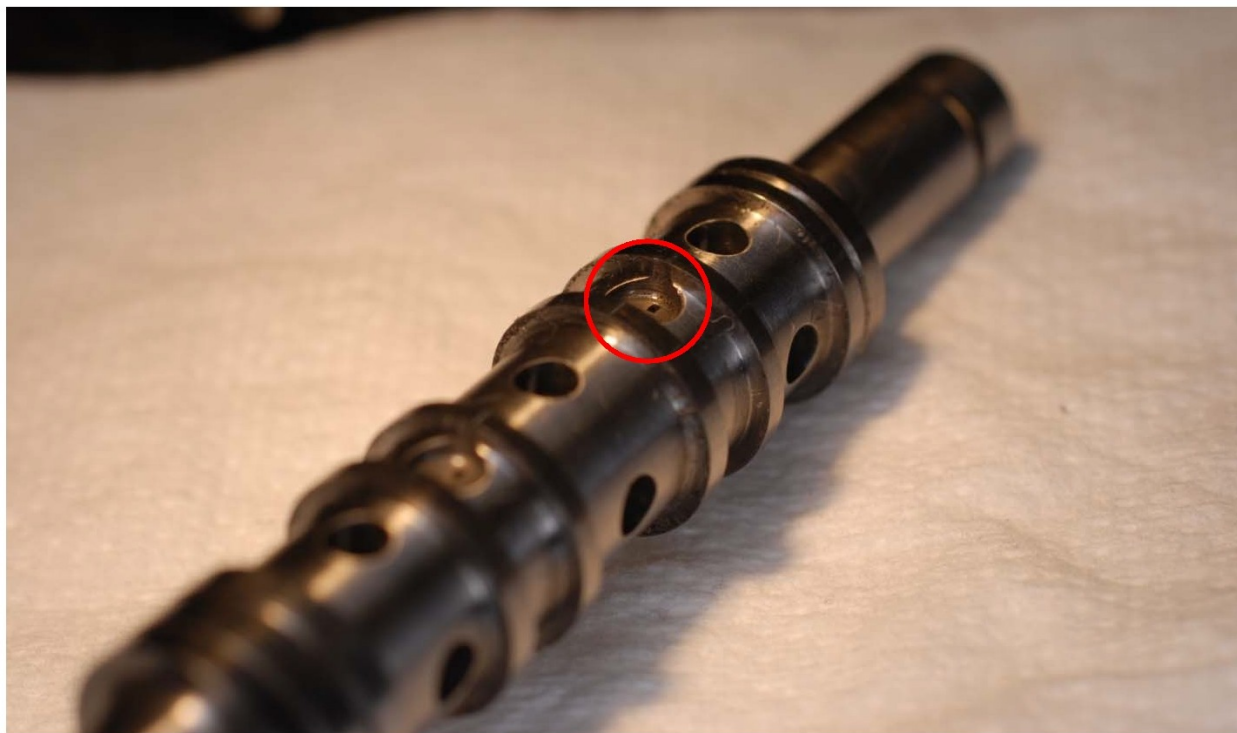
Рисунок 69. «Зарез» бурта вторичного золотника распределительного устройства правого рулевого привода
