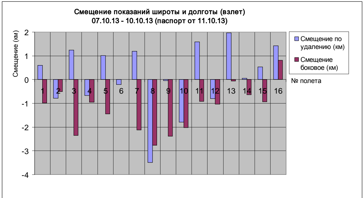
Рисунок 79. Погрешность определения местоположения инерциальной системой при взлетах 07.10-10.10.2013
