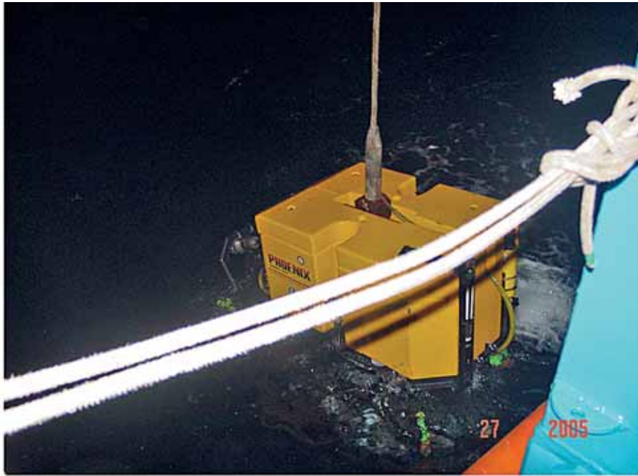
Foto 43: ROV Remora 6000, fase di lancio/immersione.
