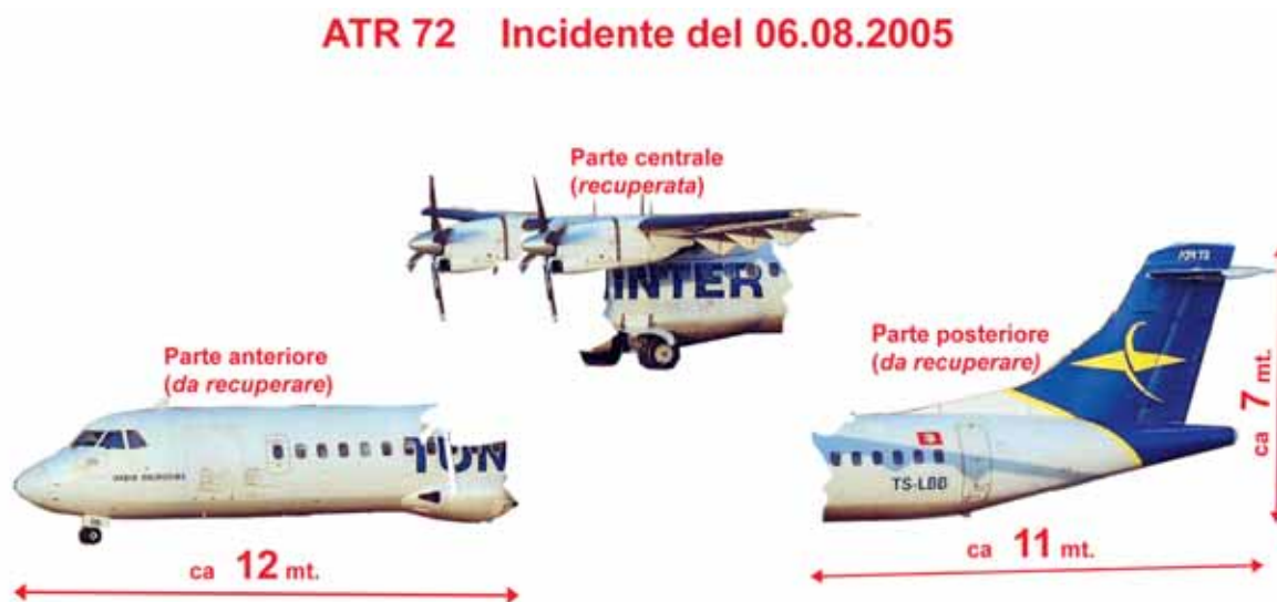
Figura 6: schema raffigurante i tre tronconi in cui si è spezzato l'aeromobile a seguito dell'impatto con la superficie del mare (ricostruzione ANSV). La dicitura "da recuperare" è riferita alla data del 6 agosto 2005. Tali parti sono state successivamente recuperate.
