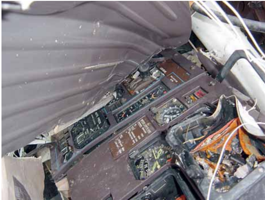
Foto 28: parte pannello strumenti TS-LBB dopo il recupero (notare, al centro della foto, la posizione della leva carrello in posizione "UP").
