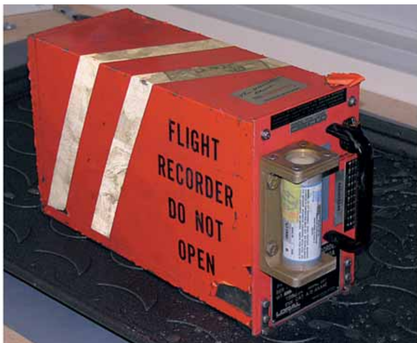
Foto 18: CVR, condizioni esterne. In primo piano, si noti l'ULB.
