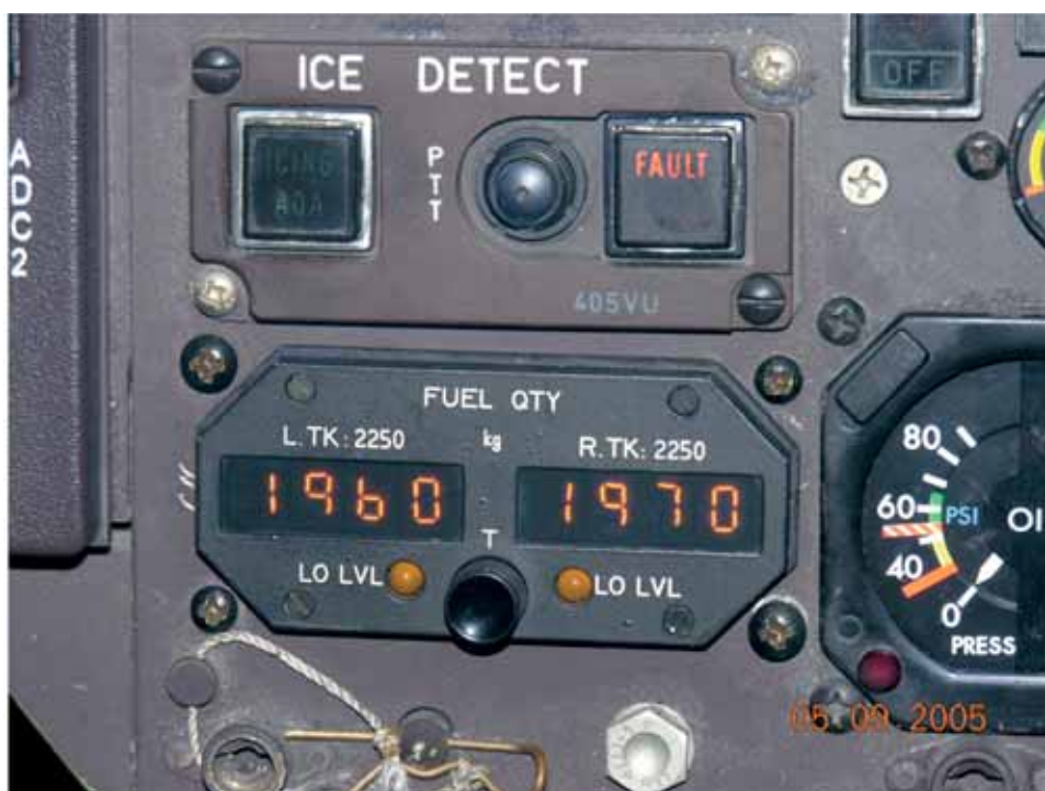
Foto 78: indicazione FQI ATR 42 su un ATR 72 con 3800 kg circa selezionati.
