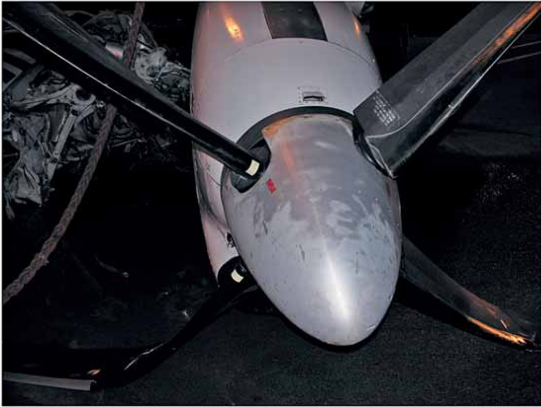
Foto 70: particolare posizione elica motore destro (bandiera).
