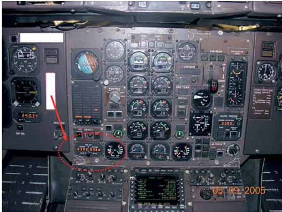
Foto 5: ATR 72, pannello centrale strumentazione (FQI indicato dalla freccia).
