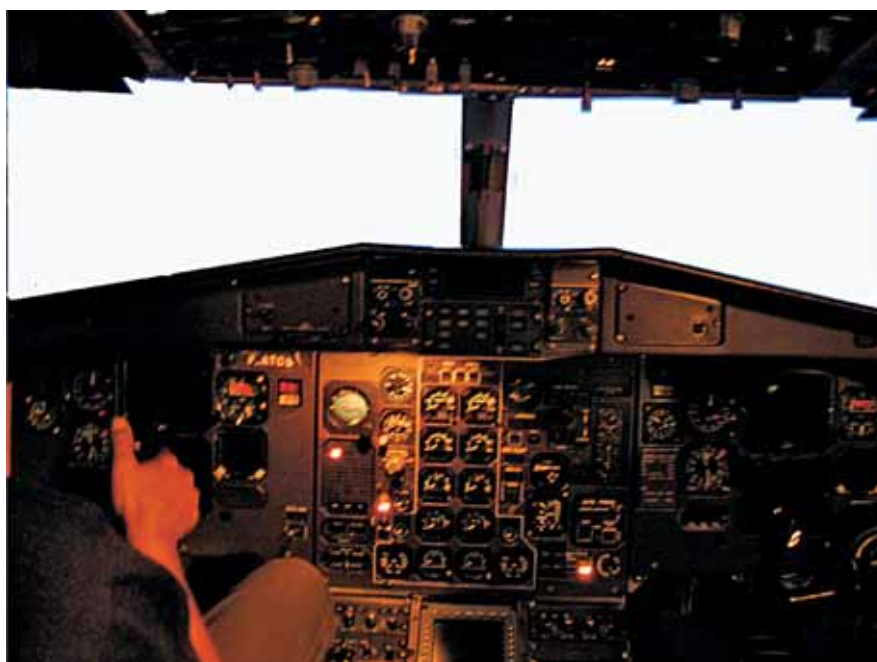
Foto 86: prove al simulatore; notare la strumentazione di stand-by (illuminata).
