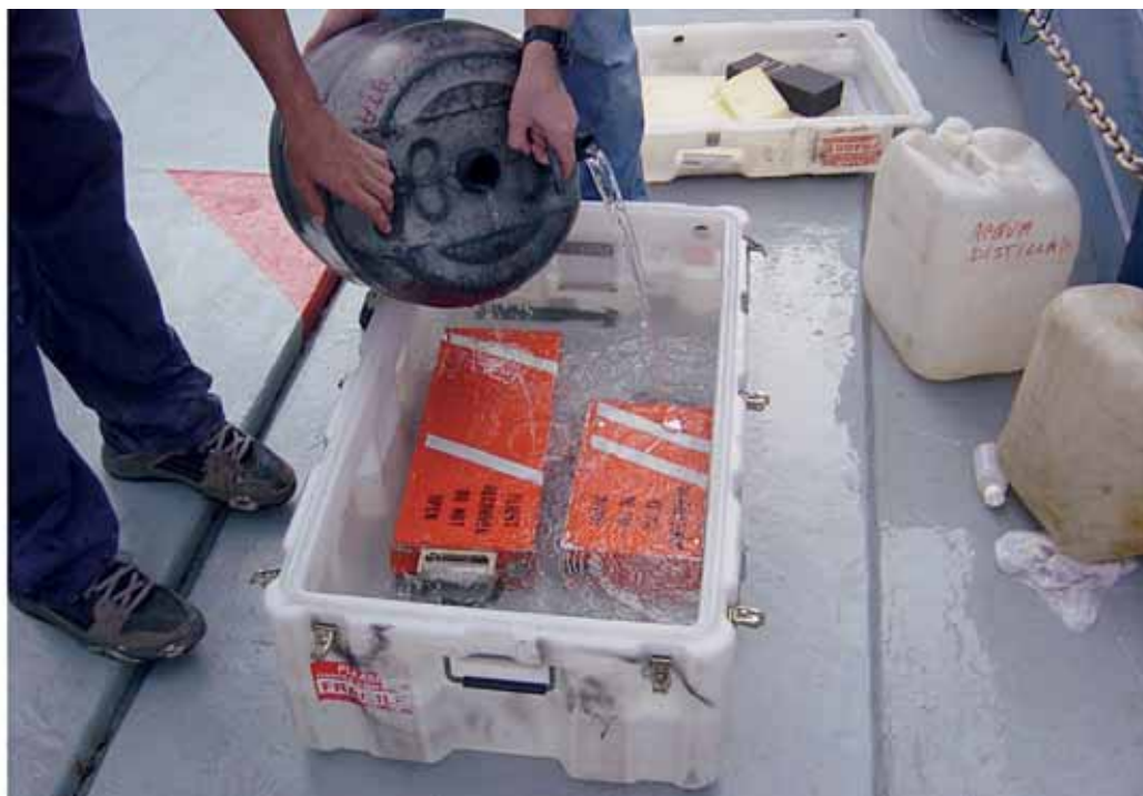
Foto 66: FDR (a sinistra) e CVR (a destra) immersi in acqua distillata per la conservazione ed il trasporto.
