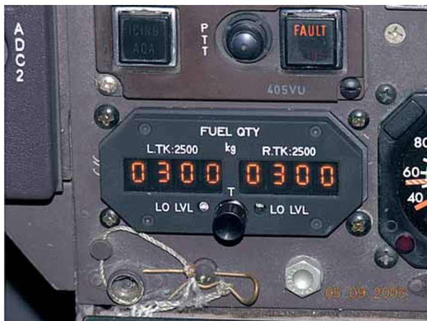
Foto 6: Fuel Quantity Indicator (indicatore quantità carburante).
