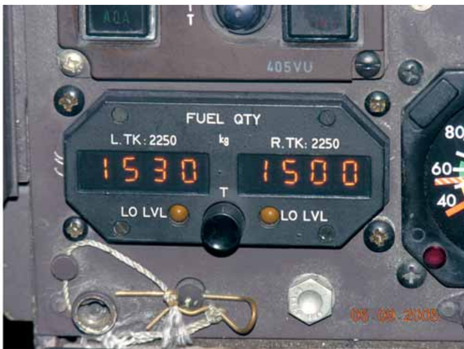
Foto 77: indicazione FQI ATR 42 su un ATR 72 con 400+400 kg di carburante per serbatoio.
