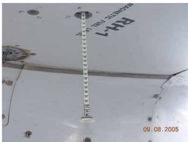
Foto 4: astina graduata ( dripstick ) per la verifica della quantità di carburante nei serbatoi alari.
