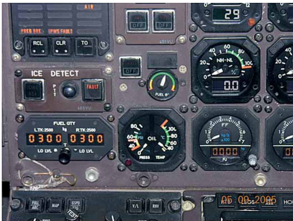
Foto 11: particolare pannello strumenti. Notare, in basso a destra, l'indicatore Fuel Flow (FF) e Fuel Used (FU).
