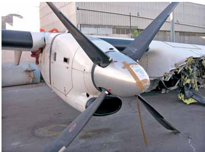
Foto 21: motore destro, notare la posizione delle eliche in bandiera (linea rossa).
