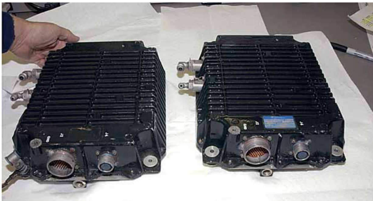
Foto 74: EEC dei motori. Notare quella a sinistra relativa al motore destro, senza targhetta identificativa.
