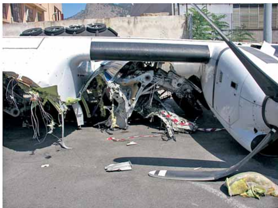
Foto 23: parte fusoliera centrale con semiali nel porto di Palermo, particolare sezione centrale.
