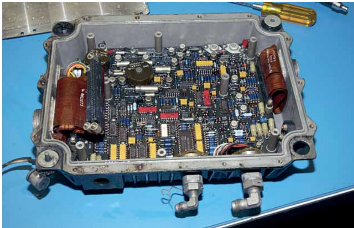
Foto 75: circuiti interni EEC.
