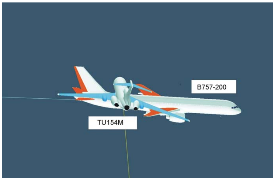
Rekonstruktion des Zusammenstoßes anhand von Flugschreiberdaten und Berührungsspuren
