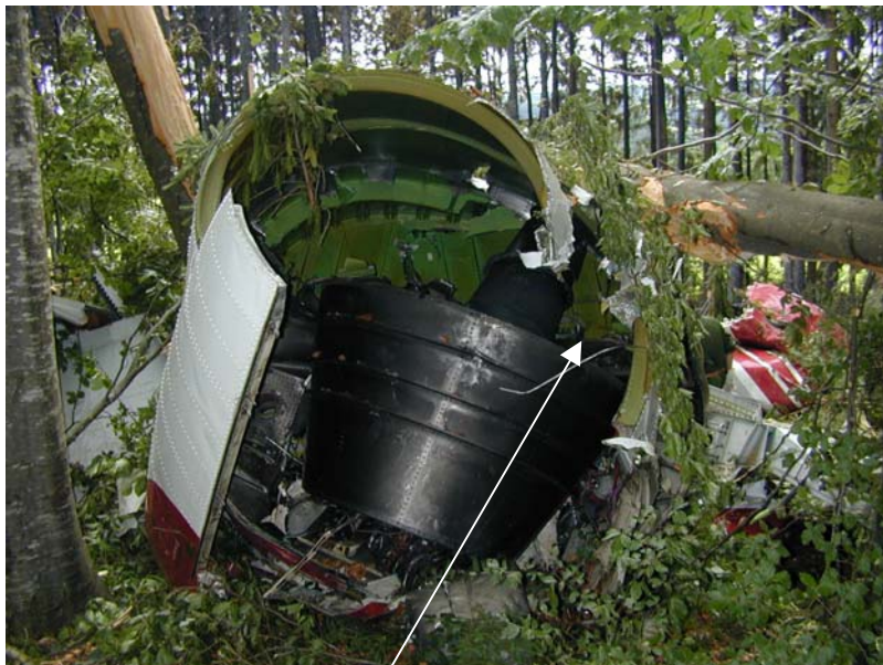
Abgasrohr der APU
