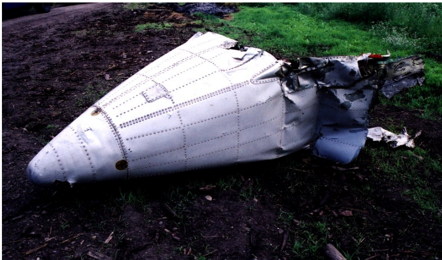
Verkleidung des rechten Hauptfahrwerks
