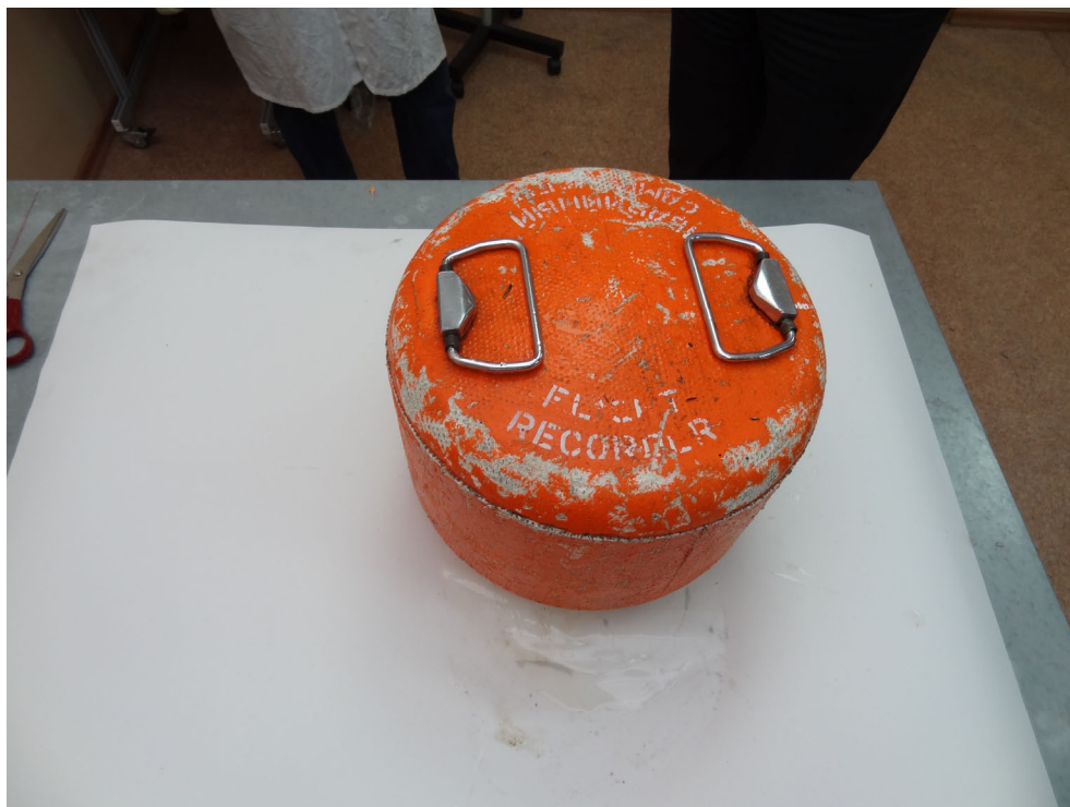
Рисунок 4. Внешний вид защищенного блока 70А-10М № 264018
