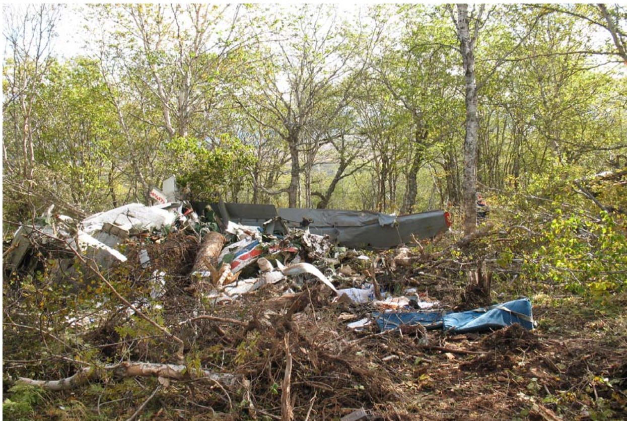
Рис. № 6. Разброс фрагментов кабины пилотов и пассажирской кабины.
