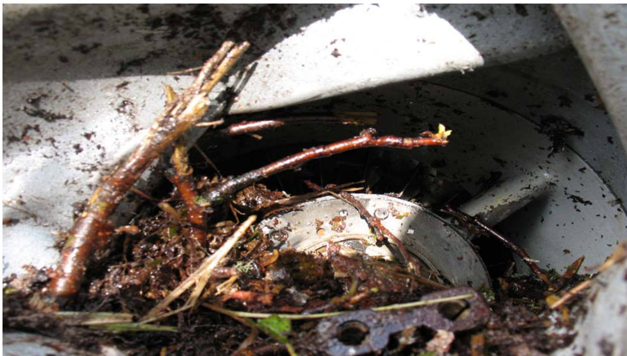
Рис. № 11. Входной направляющий аппарат двигателя с древесным материалом.
