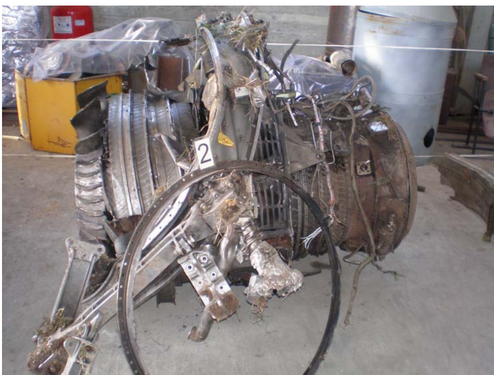
Вентилятор с компрессором правого двигателя
