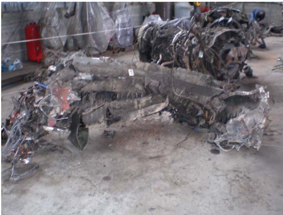
Корпус вентилятора левого двигателя
